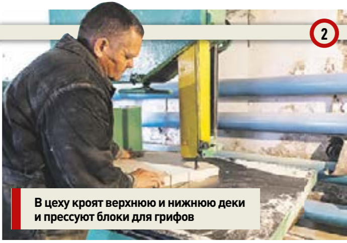
1 Для производства верхней деки гитар используется резонансная ель, на обечайку (гнутую часть гитары), гриф, подставку и нижнюю деку (дно) идут березовый шпон, береза, бук, а также тонкая авиационная фанера
