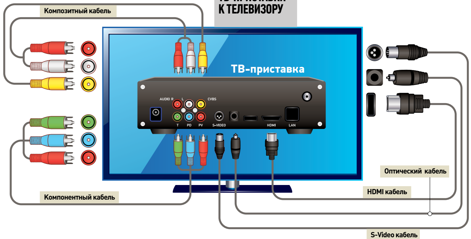
Специальная цифровая приставка к телевизору (SET TOP BOX, цифровой эфирный ресивер) с тюнером DVB-T2/MPEG-4 и поддержкой режима MULTIPLE PLP
