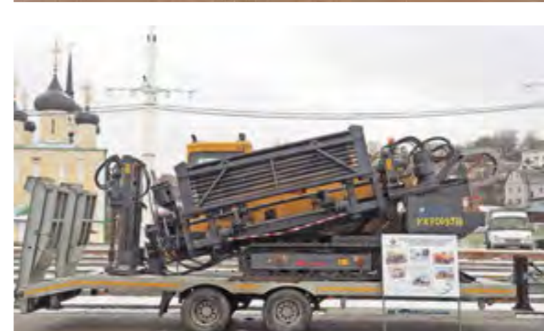
С помощью машины для горизонтально направленного бурения коммунальщики проводят трубы не вскрывая поверхность земли
